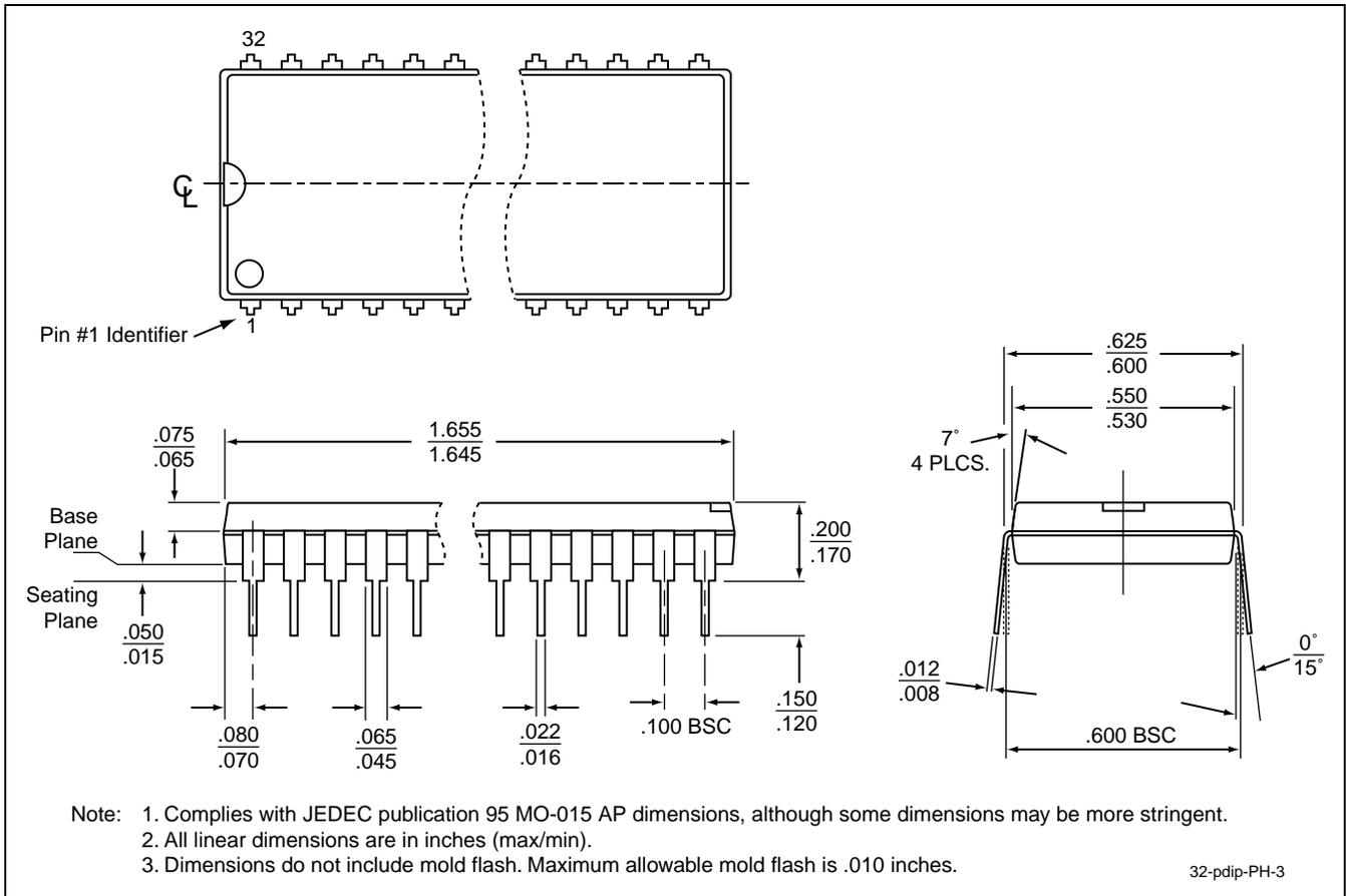
**32-PIN PLASTIC DUAL IN-LINE PINS (PDIP)**
