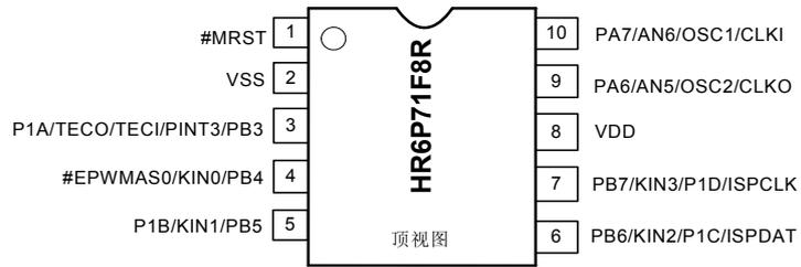
图 1-4 HR6P71 (SSOP10) 顶视图
