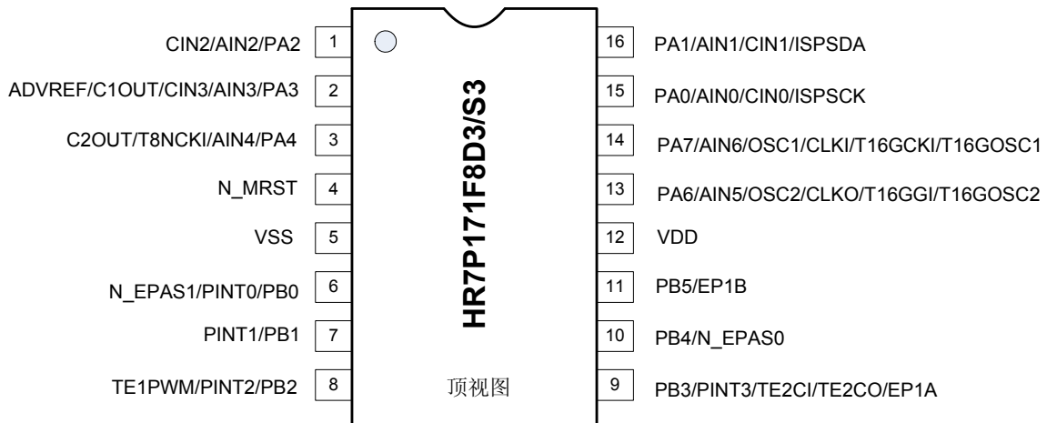
图 1-4 HR7P171 (DIP16/SOP16) 顶视图
