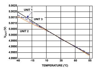
FIGURE 21.  $V_{OUT}$  vs TEMPERATURE (3 UNITS)
