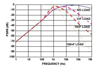
FIGURE 22. PSSR vs CAP LOAD
