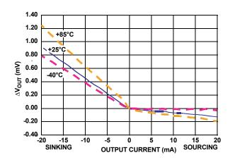
FIGURE 19. LOAD REGULATION OVER TEMPERATURE
