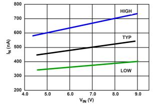
FIGURE 1. I<sub>IN</sub> vs V<sub>IN</sub> (3 UNITS)
