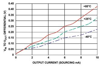
FIGURE 27. MINIMUM  $V_{\text{IN}}$  TO  $V_{\text{OUT}}$  DIFFERENTIAL vs OUTPUT CURRENT
