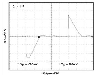
FIGURE 9. LINE TRANSIENT RESPONSE, 0.001µF LOAD CAPACITANCE
