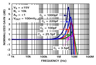
FIGURE 30. GAIN vs FREQUENCY vs CL
