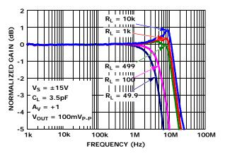
FIGURE 29. GAIN vs FREQUENCY vs R<sub>L</sub>
