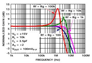
FIGURE 28. FREQUENCY RESPONSE vs FEEDBACK RESISTANCE  $R_{\rm f}/R_{\rm g}$
