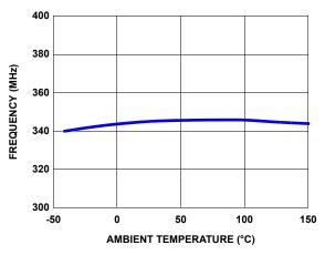
FIGURE 14. FREQUENCY vs TEMPERATURE
