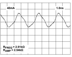
FIGURE 18. OUTPUT CURRENT AT 350MHz
