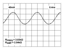
FIGURE 19. OUTPUT CURRENT AT 600MHz
