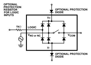
FIGURE 9. INPUT OVERVOLTAGE PROTECTION
