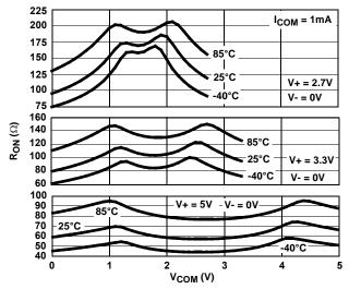
FIGURE 12. ON RESISTANCE vs SWITCH VOLTAGE
