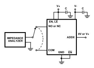
FIGURE 8. CAPACITANCE TEST CIRCUIT
