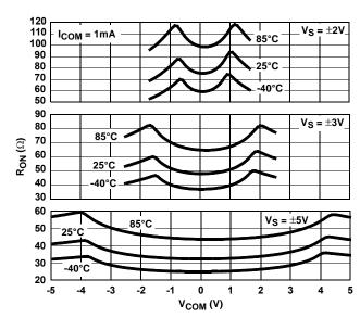
FIGURE 11. ON RESISTANCE vs SWITCH VOLTAGE
