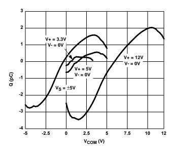
FIGURE 21. CHARGE INJECTION vs SWITCH VOLTAGE
