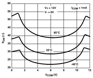
FIGURE 13. ON RESISTANCE vs SWITCH VOLTAGE
