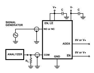
FIGURE 5. OFF ISOLATION TEST CIRCUIT
