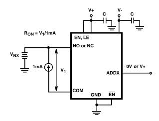
FIGURE 6. R<sub>ON</sub> TEST CIRCUIT
