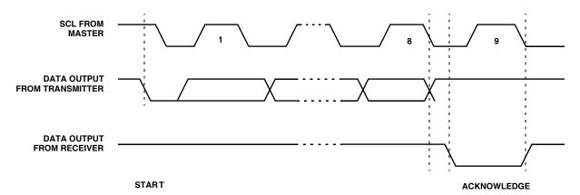
FIGURE 7. ACKNOWLEDGE RESPONSE FROM RECEIVER
