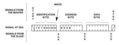
FIGURE 14. BYTE WRITE SEQUENCE
