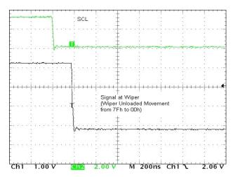
FIGURE 10. LARGE SIGNAL SETTLING TIME
