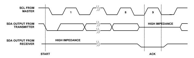
FIGURE 13. ACKNOWLEDGE RESPONSE FROM RECEIVER
