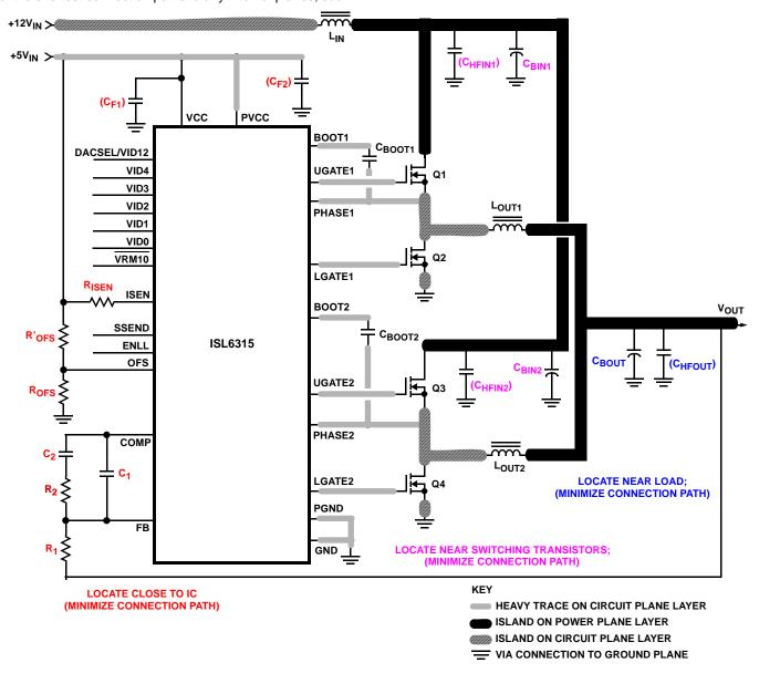
FIGURE 10. PRINTED CIRCUIT BOARD POWER PLANES AND ISLANDS
