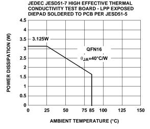
FIGURE 38. PACKAGE POWER DISSIPATION VS AMBIENT TEMPERATURE
