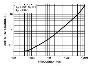
FIGURE 24. OUTPUT IMPEDANCE vs FREQUENCY
