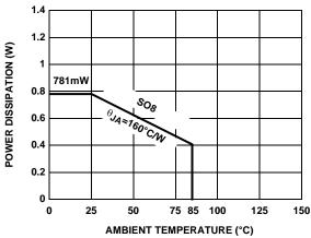
FIGURE 37. PACKAGE POWER DISSIPATION vs AMBIENT TEMPERATURE
