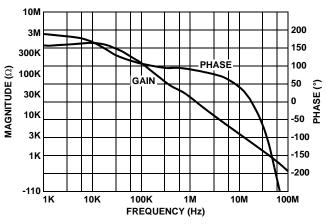
FIGURE 22. TRANSIMPEDANCE (R<sub>OL</sub>) vs FREQUENCY
