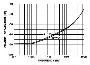
FIGURE 20. CHANNEL SEPARATION vs FREQUENCY
