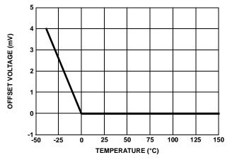
FIGURE 31. OFFSET VOLTAGE vs TEMPERATURE
