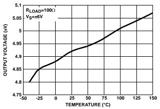
FIGURE 33. OUTPUT VOLTAGE vs TEMPERATURE
