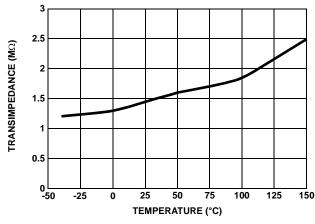
FIGURE 32. TRANSIMPEDANCE vs TEMPERATURE
