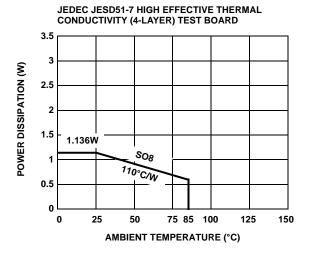
FIGURE 36. PACKAGE POWER DISSIPATION VS AMBIENT TEMPERATURE
