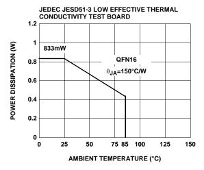
FIGURE 39. PACKAGE POWER DISSIPATION VS AMBIENT TEMPERATURE
