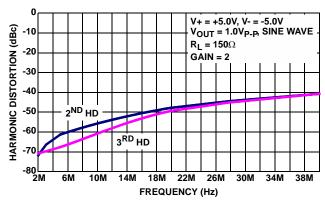
FIGURE 19. HARMONIC DISTORTION vs FREQUENCY
