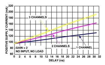
FIGURE 22. ISL59922 POSITIVE SUPPLY CURRENT (V<sub>SP</sub>) vs DELAY TIME
