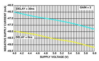
FIGURE 30. ISL59923 I<sub>SUPPLY</sub>- vs V<sub>SUPPLY</sub>-
