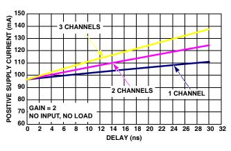
FIGURE 23. ISL59923 POSITIVE SUPPLY CURRENT (V<sub>SP</sub>) vs DELAY TIME
