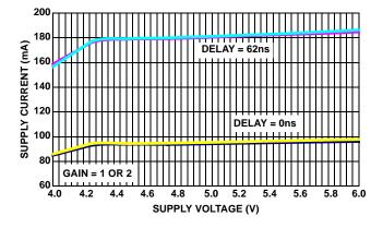
FIGURE 24. ISL59920 I<sub>SUPPLY</sub>+ vs V<sub>SUPPLY</sub>+
