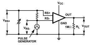
FIGURE 15. SLEW RATE, t<sub>s</sub>, SATURATION RECOVERY TIME
