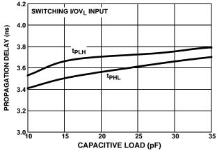
FIGURE 17. PROPAGATION DELAY vs I/OV<sub>CC</sub> CAPACITIVE LOAD
