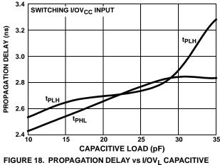
FIGURE 18. PROPAGATION DELAY vs I/OV<sub>L</sub> CAPACITIVE LOAD
