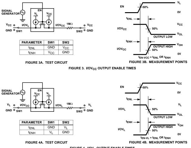
FIGURE 4. I/OV<sub>L</sub> OUTPUT ENABLE TIMES
