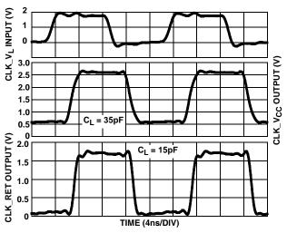
FIGURE 21. ISL3035E CLOCK WAVEFORMS (100Mbps)
