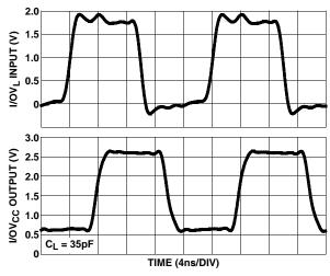
FIGURE 19. I/OV<sub>CC</sub> OUTPUT WAVEFORMS (100Mbps)
