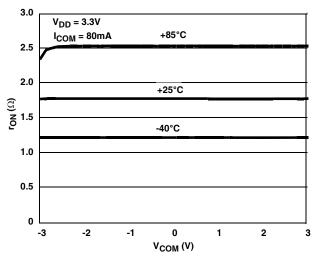
FIGURE 9. ON-RESISTANCE vs SWITCH VOLTAGE
