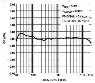
FIGURE 15. GAIN vs FREQUENCY
