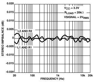
FIGURE 16. STEREO IMBALANCE vs FREQUENCY
