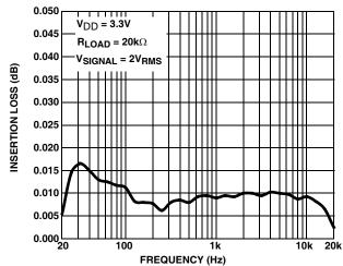
FIGURE 14. INSERTION LOSS vs FREQUENCY
