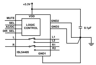
FIGURE 7. STAR GROUNDING CONFIGURATION
