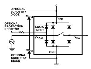
FIGURE 8. OVERVOLTAGE PROTECTION
