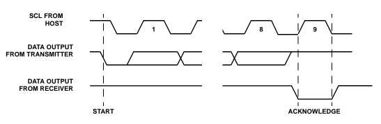
FIGURE 15. ACKNOWLEDGE RESPONSE FROM RECEIVER
