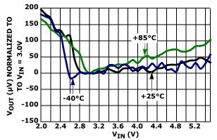
FIGURE 5. LINE REGULATION OVER-TEMPERATURE
