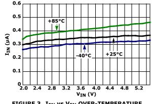
FIGURE 3. IIN vs VIN OVER-TEMPERATURE
