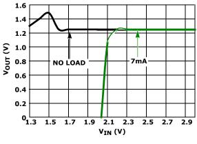
FIGURE 29. DROPOUT, ISL21080-12
