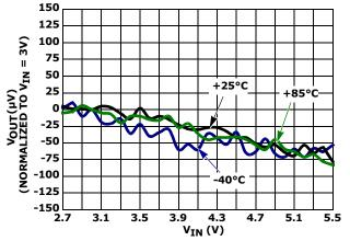
FIGURE 17. LINE REGULATION OVER-TEMPERATURE
