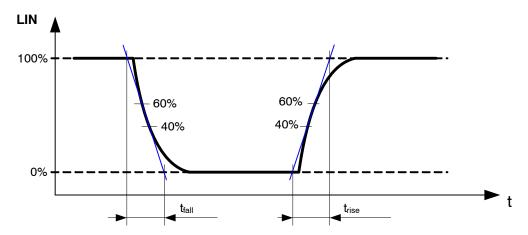
Figure 12. Definition of LIN Edge Parameters
