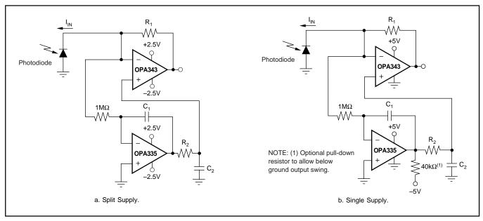
FIGURE 4. Auto-Zeroed Transimpedance Amplifier.
