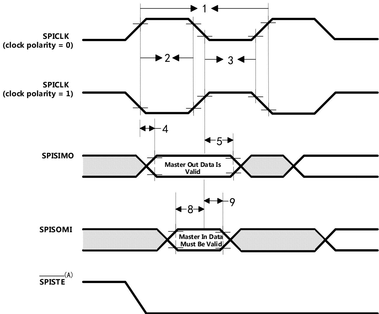
A. 在主控模式下，在有效的 SPI 时钟边沿之前  $0.5t_c(SPC)$ （最小值）， $\overline{SPISTE}$  变为有效。在字的尾端， $\overline{SPISTE}$  在接收到最后一个数据位的边沿(SPICLK) 之后  $0.5t_c (SPC)$  将变为无效，除非  $\overline{SPISTE}$  在 FIFO 和非 FIFO 模式中的背靠背传送字间保持有效。
