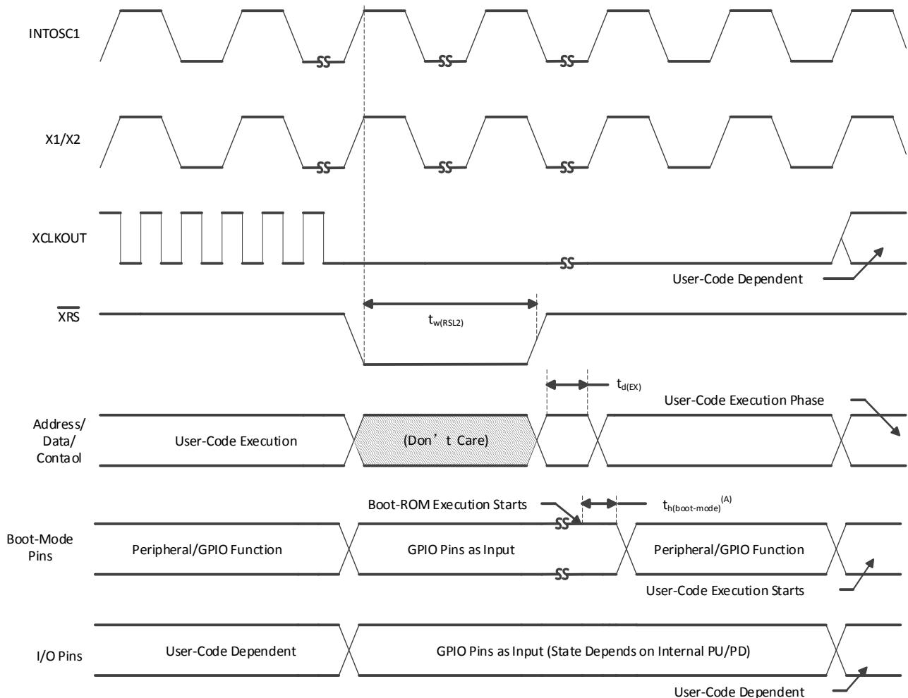
A. 复位后，引导 ROM 代码采样 BOOT 模式引脚。基于引导模式引脚的状态，引导代码向目的内存或者引导代码函数下达分支指令。
