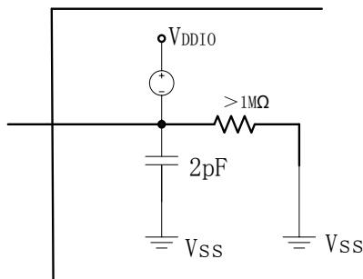
图6-14 针对带有内部上拉电阻的 GPIO 引脚的输入电阻模型
