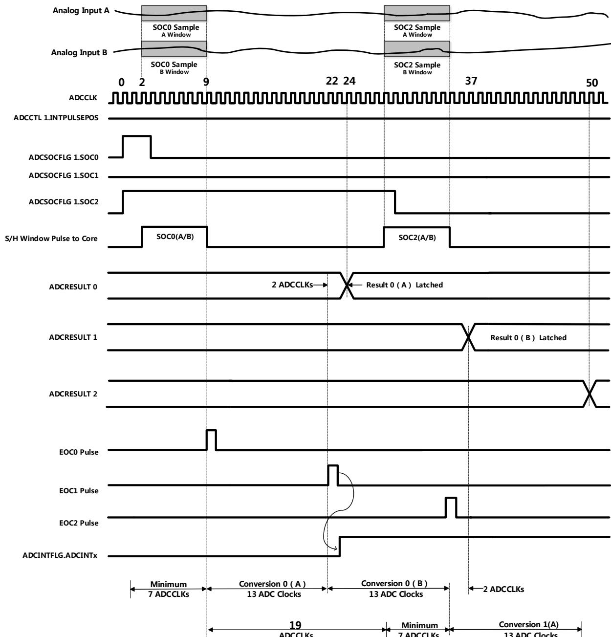
图6-31 针对同步模式/早期中断脉冲的时序示例
