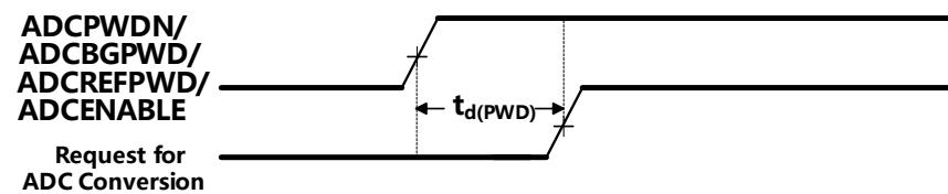
图6-26 ADC 转换时序
