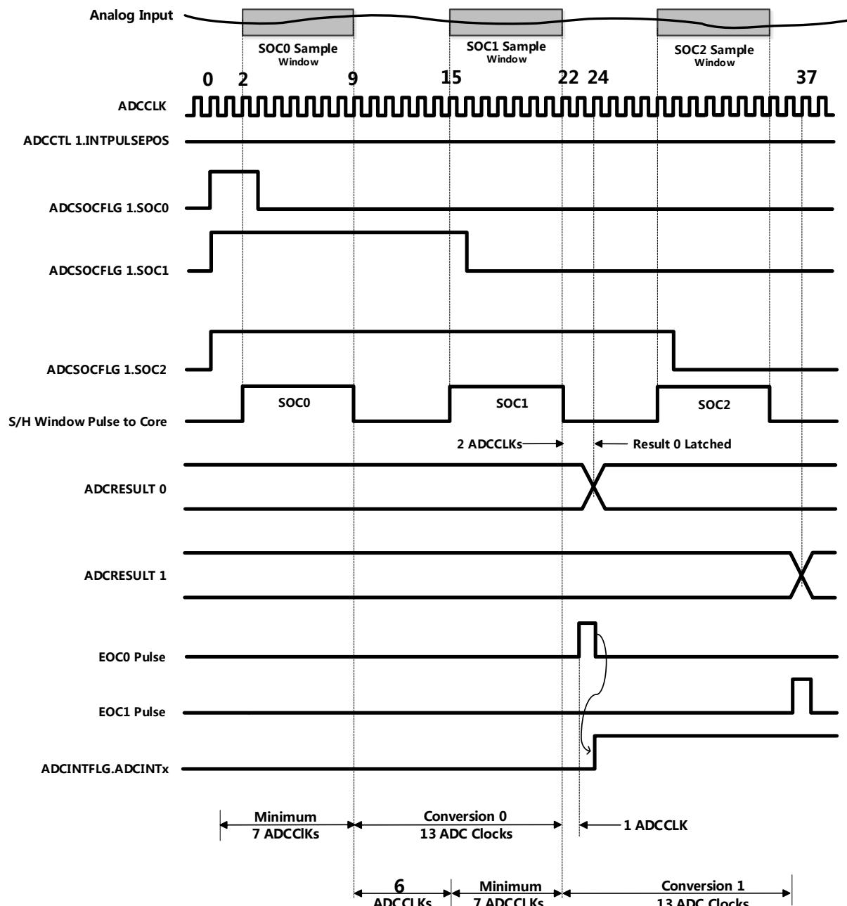
图6-28 针对顺序模式/后期中断脉冲的时序示例
