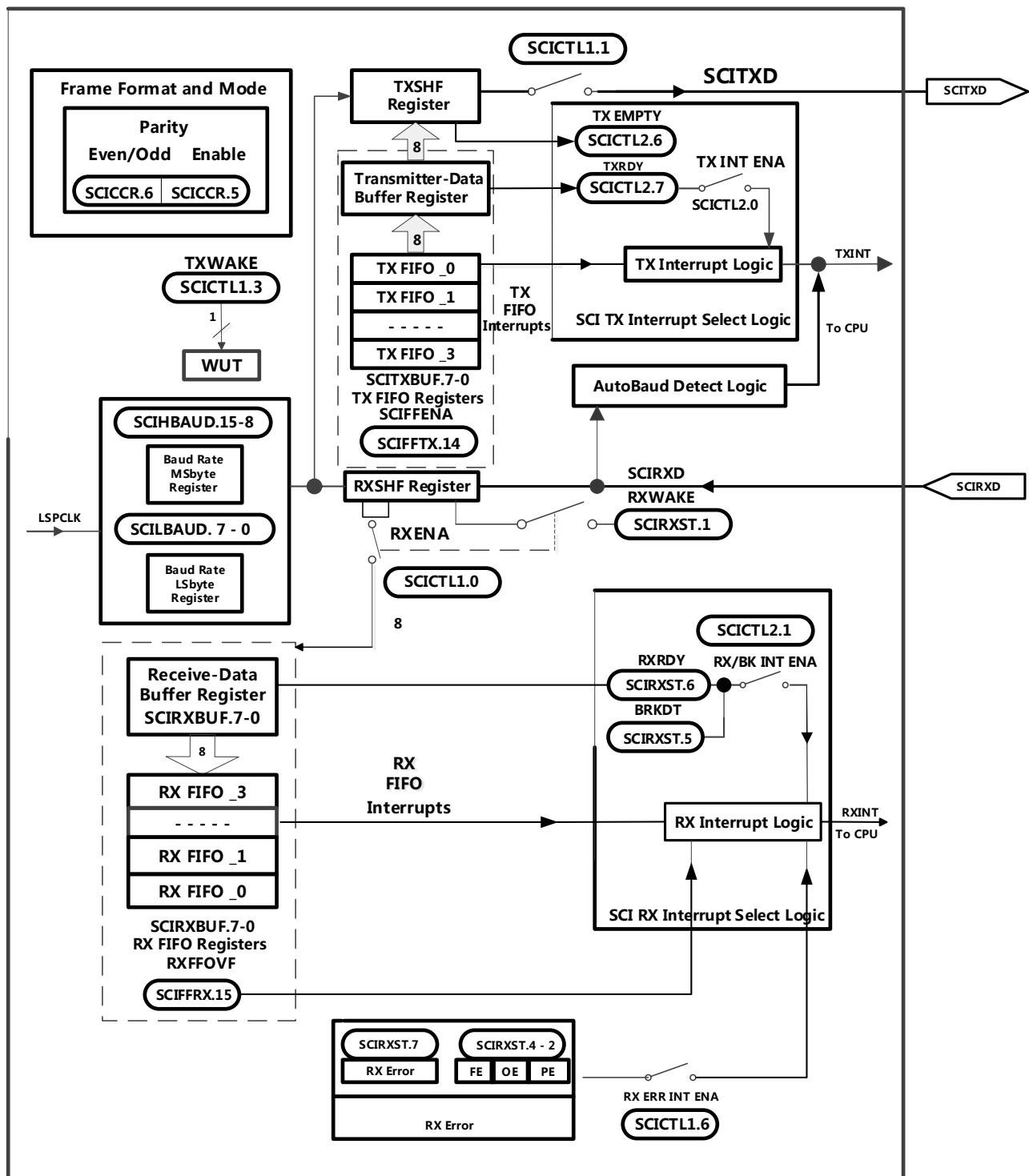
图4-7 串行通信接口(SCI) 模块方框图
