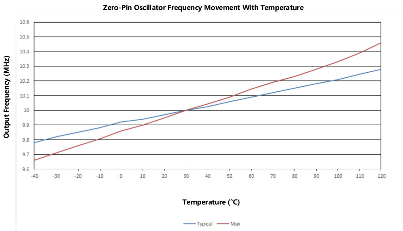
图 6-6 随着温度发生变动的零引脚振荡器频率
