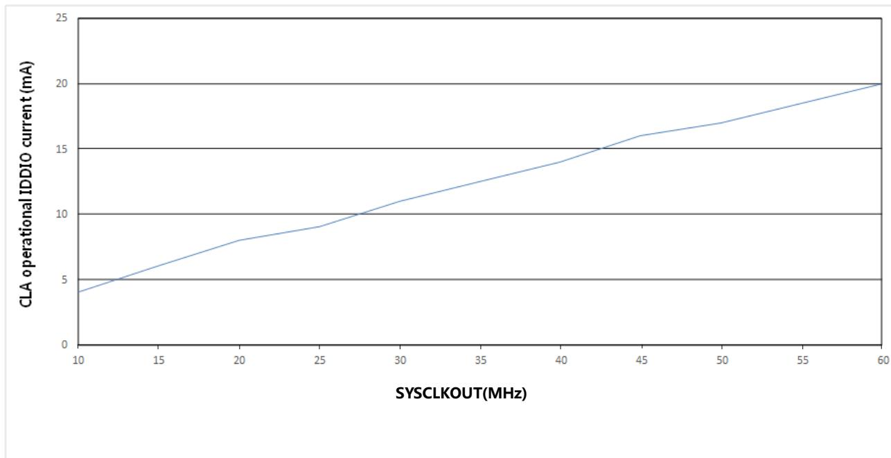
图 6-3 典型 CLA 运行电流与 SYSCLKOUT 间的关系
