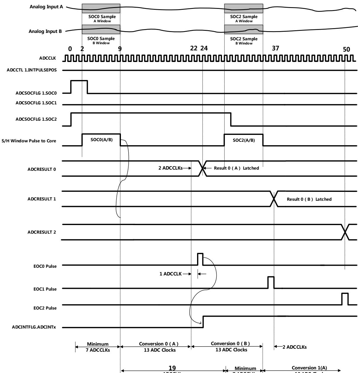
图6-30 针对同步模式/晚期中断脉冲的时序示例
