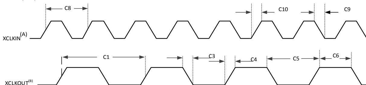
A. XCLKIN 与 XCLKOUT 的关系取决于所选择的分频因子。图5-10中显示的波形关系只用于解释时序参数并且根据实际配置会有所不同。
