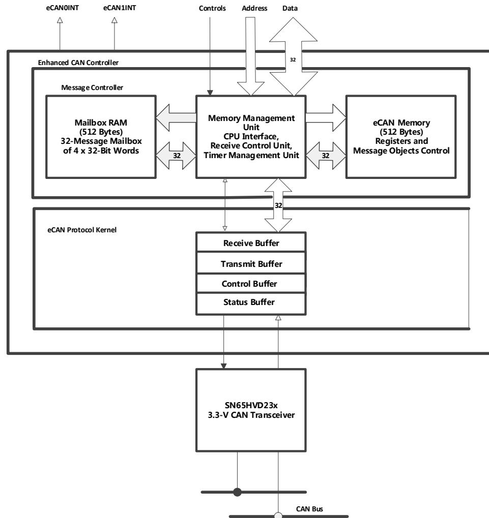
图 4-9 eCAN 方框图和接口电路
