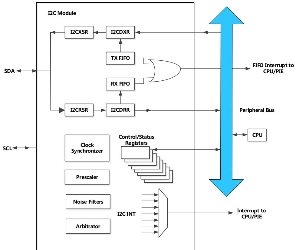
A. 在 SYSCLKOUT 速率上对 I2C 寄存器进行访问。I2C 端口的内部定时和信号波形也为 SYSCLKOUT 速率。
