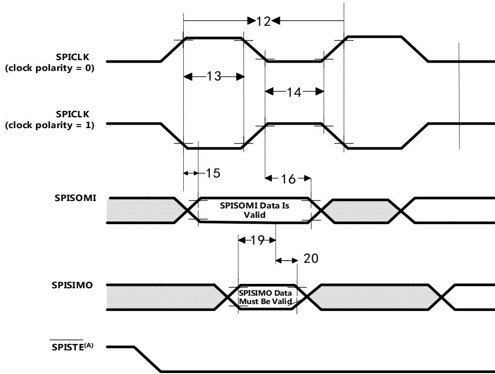
图6-23 SPI 受控模式外部时序 (时钟相位= 0 )
