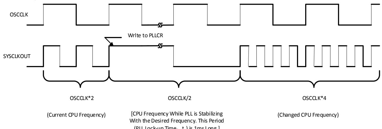
图6-10 写入 PLLCR 寄存器所产生的效果的示例
