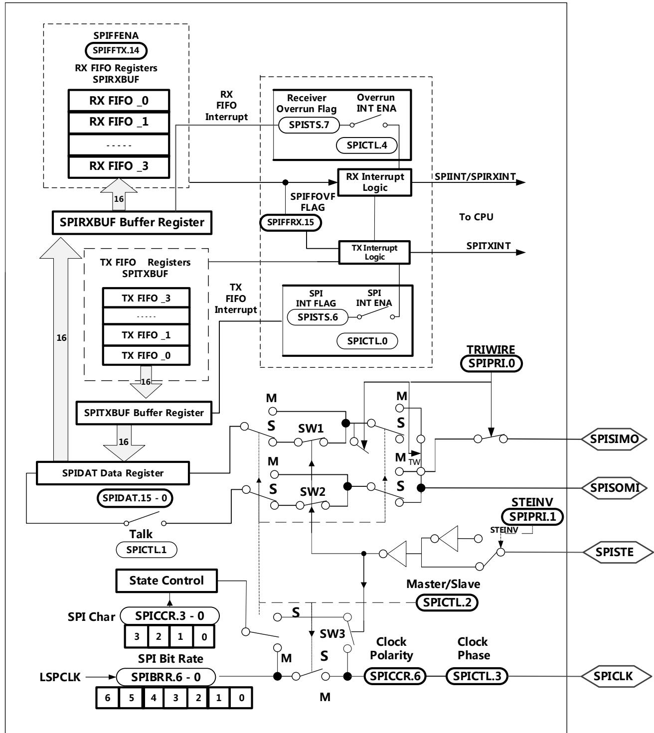
A.  $\overline{\text{SPISTE}}$ 被主控器件驱动为用于受控器件的低电平。
