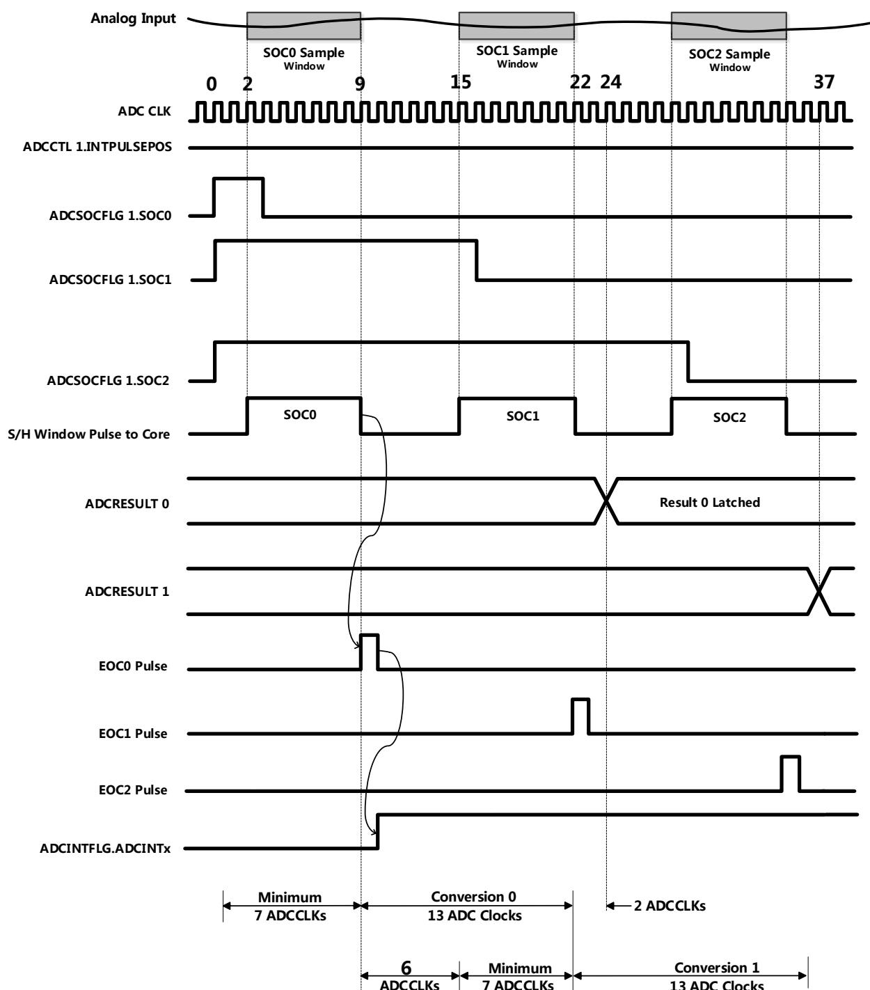
图6-29 针对顺序模式/早期中断脉冲的时序示例
