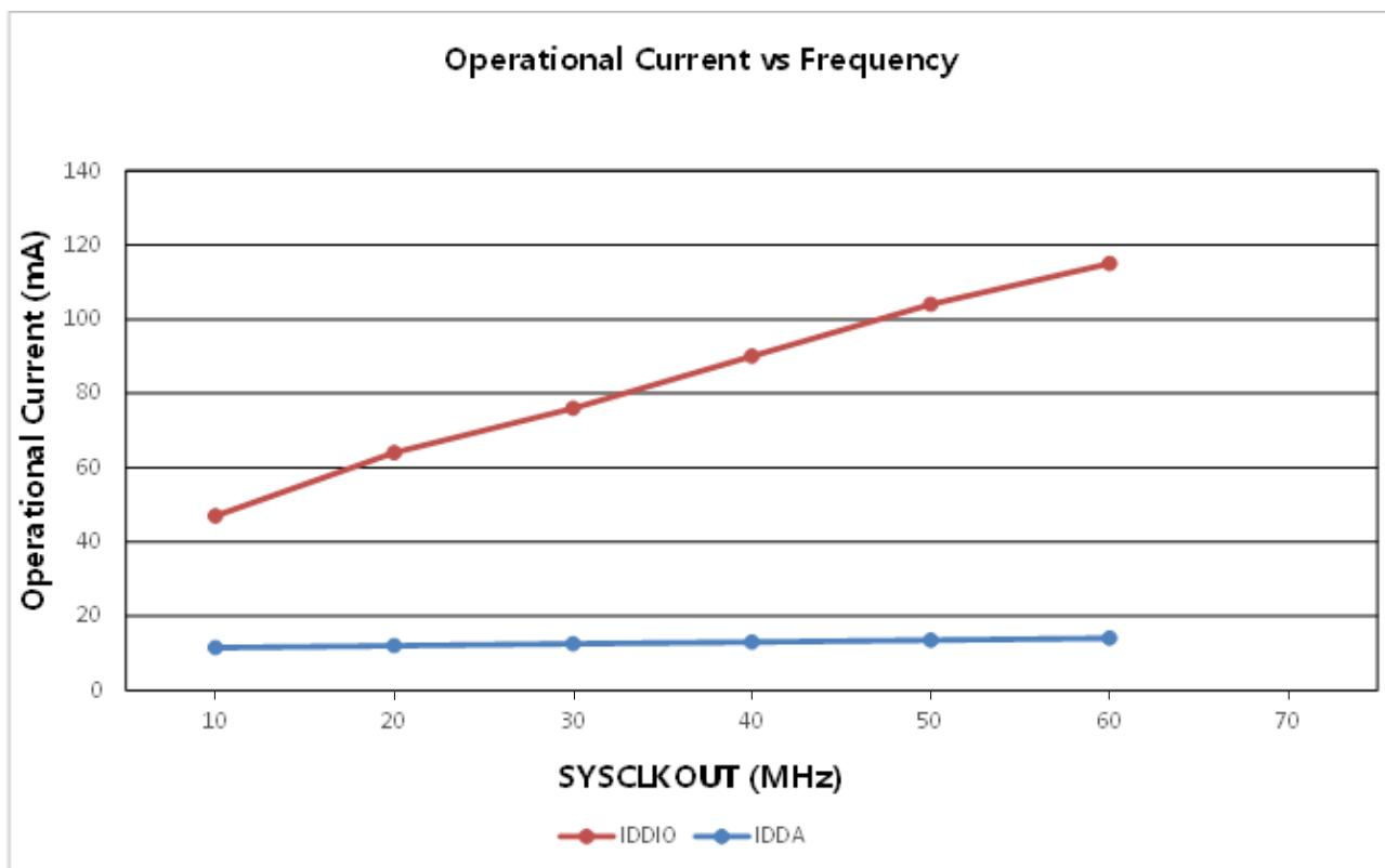
图 6-1 典型运行电流与频率间的关系 (ADP32F035)
