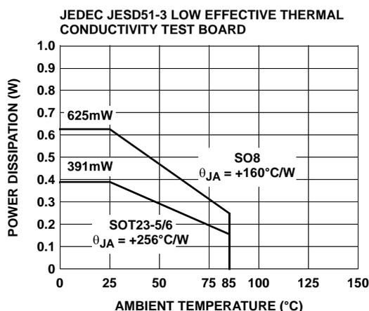
FIGURE 26. PACKAGE POWER DISSIPATION vs AMBIENT TEMPERATURE
